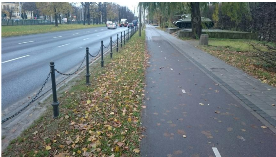
Ilustracja 14: Separacja ruchu rowerowego od ruchu samochodowego oraz zastosowane inne rzędne chodnika, opracowanie własne
