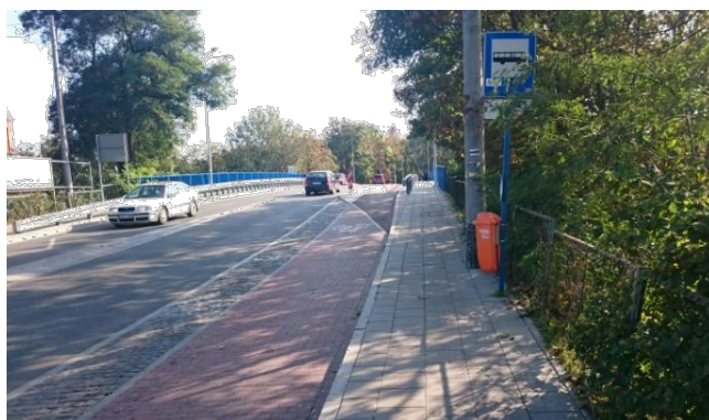
Ilustracja 20, Przeprowadzenie pasa rowerowego w rejonie zatoki autobusowej, opracowanie własne
